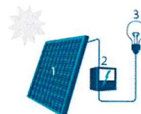
1. Zonnepaneel | 2. Omvormer | 3. Elektrische toestellen
